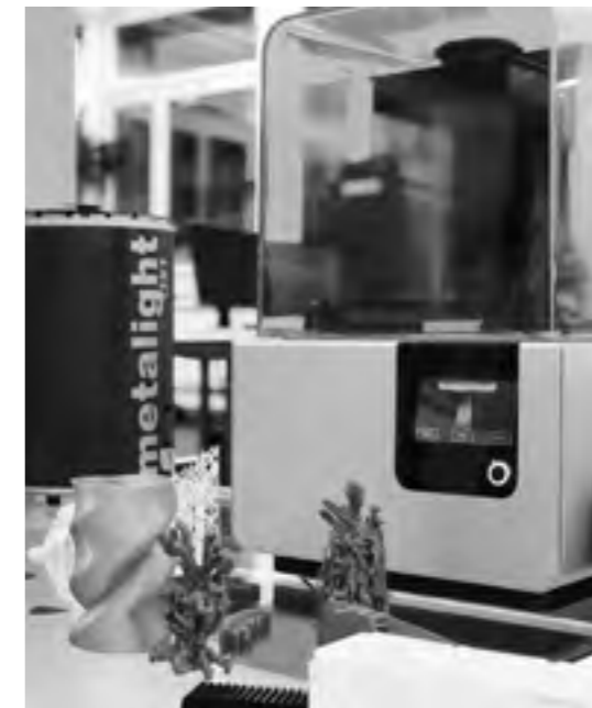
Spielt Qualität im Druck eine wichtige Rolle? Dann hilft der „Form 2“ weiter, 3D Druck mit Kunstharz. FabLab-Zug fürs Prototyping.
